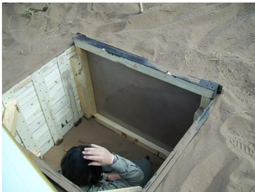
**Figura 7:** Rizotróf instalado en el campo para observar las raíces finas creciendo
