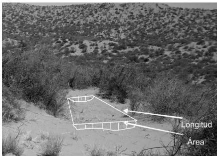
Figura 1. Determinación de la cubeta de erosión hídrica a campo y parámetros medidos para su caracterización
