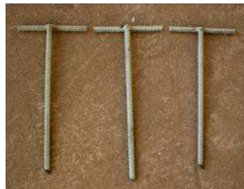
Figura 10: Clavos fabricados con hierros de construcción nervurado de 8 mm de diámetro y 20 cm de largo.
