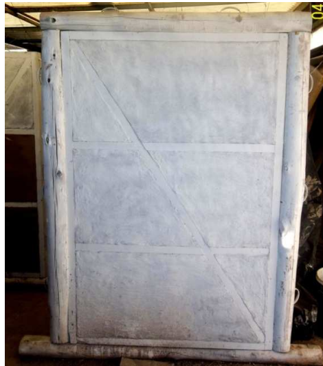
Figura 7: Panel de quincha para ensayo a carga horizontal.
