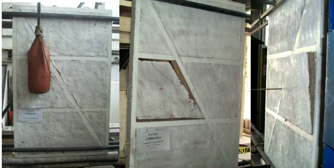
Figura 3: Secuencia de ensayo de choque blando en panel de quincha.
