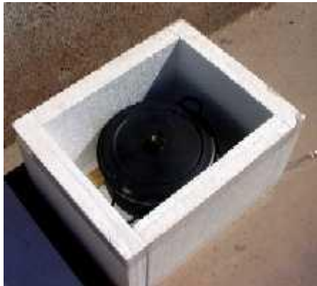
Figura 4: Caja térmica de poliestireno expandido (telgopor) con la olla dentro. La olla apoya en una madera, pero no tiene aún el forro de aluminio por el
