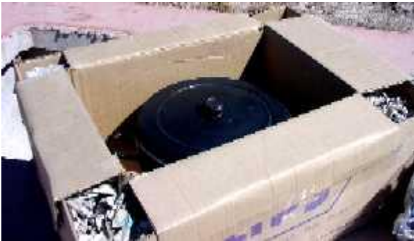
Figura 2: Caja térmica armada con dos cajas de cartón y pelotitas de papel de diario entre ellas con la olla dentro. Es importante que la olla entre bien en el interior.
