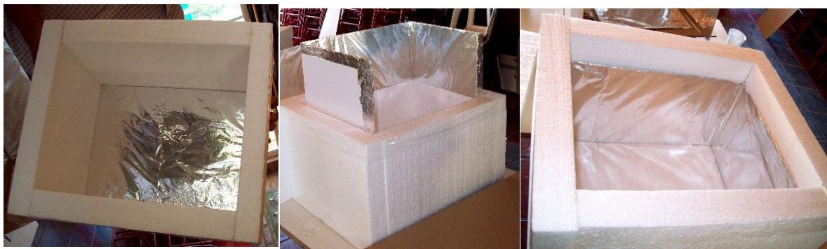
Figura 7: colocación de la barrera radiante en la caja. Una vez envuelto el cartón corrugado del piso, de las paredes y la tapa, se coloca en el interior con algo de pegamento (que sea pegamento apto para telgopor) . Se observa que la barrera radiante del costado deja lugar para que ingrese la tapa perfectamente y con la barrera colocada en la tapa, se cubre todo el interior.
