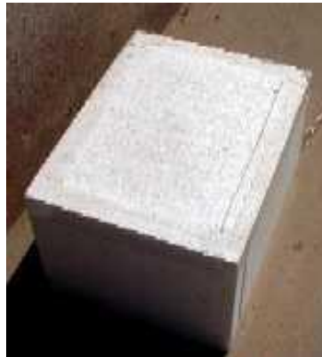
Figura 5: caja térmica de poliestireno expandido. Se incorpora la tapa. Se observa que la olla entra perfectamente bien.
