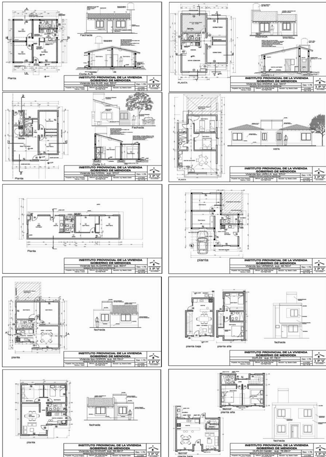
Figura 2. Las diez tipologías de viviendas sociales que se construyen en Mendoza bajo el Plan Federal de Vivienda.
